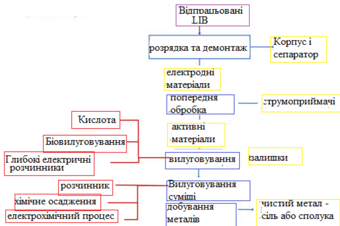
Рисунок 2.4 - Схема гідрометалургійної процедури переробки відпрацьованих LiB
