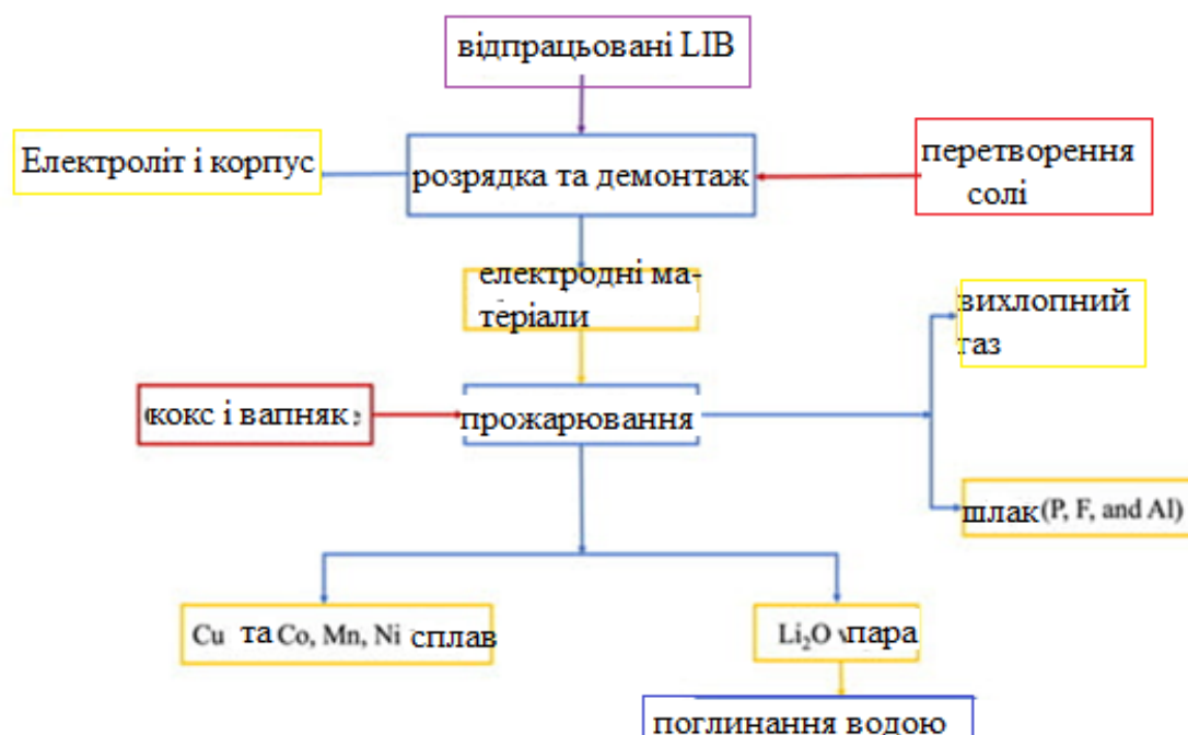
Рисунок 2.3 - Схема процесу пірометалургійної переробки відпрацьованих LiB
