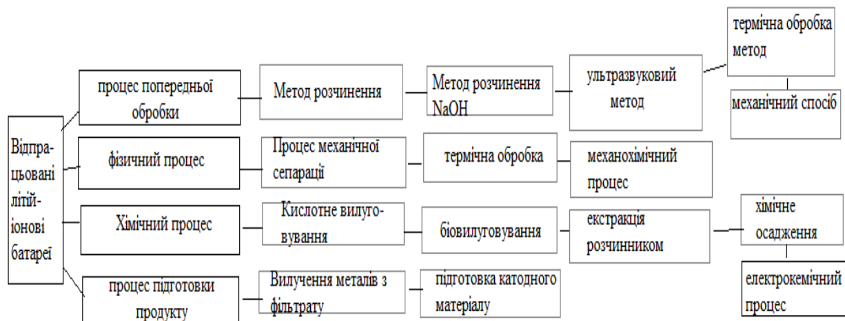
Рисунок 2.2 - Схема переробки відпрацьованих літій-іонних батарей
