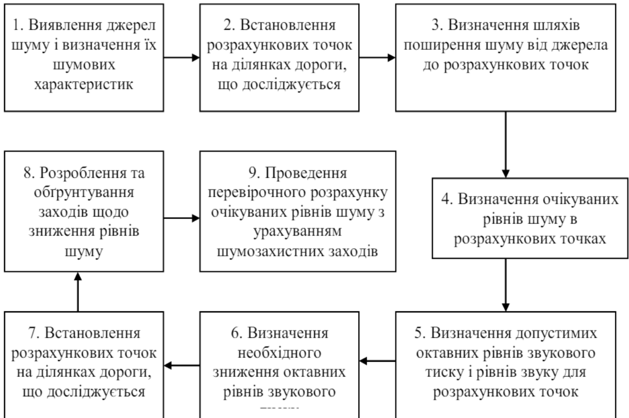
Рисунок 1.4 – Спрощена схема алгоритму проведення акустичного розрахунку транспортного шуму на ділянках вулично-дорожньої мережі
