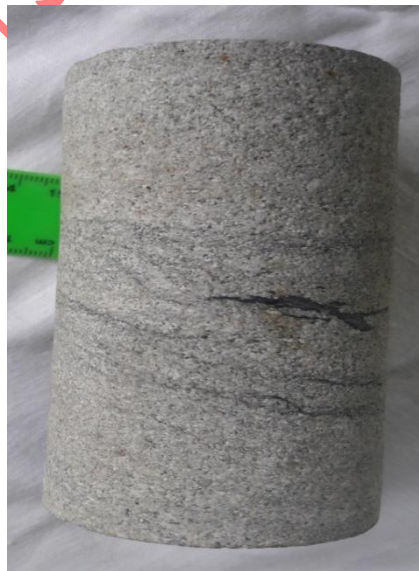
Рисунок 5.6 - Викиднебезпечний пісковик з включеннями органіки середне
