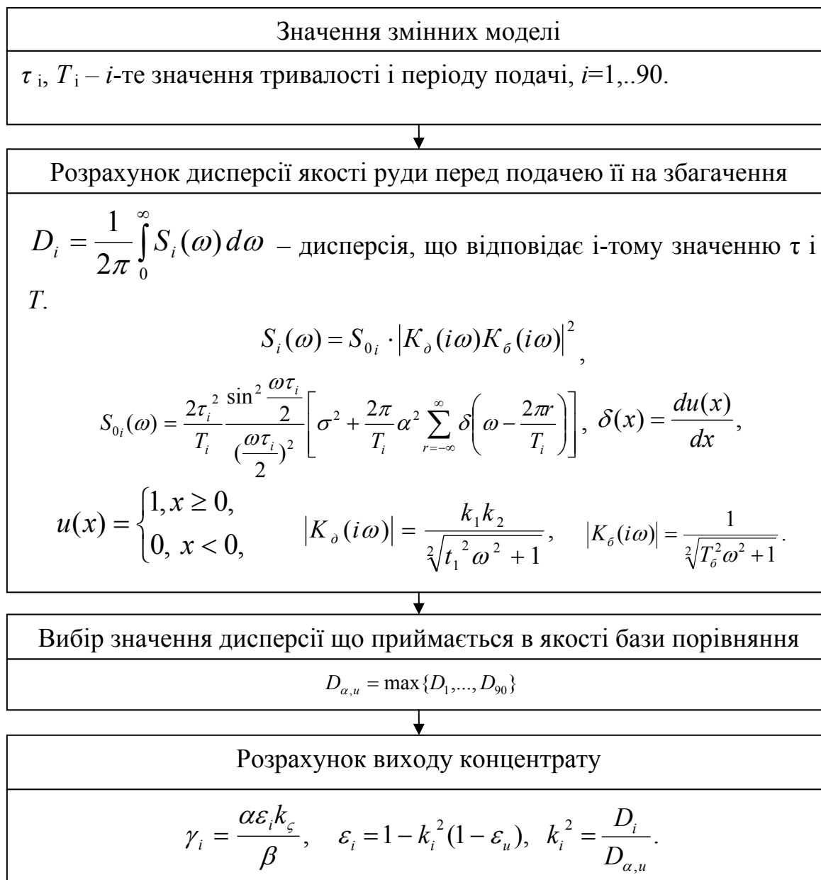
Рисунок 2.26 - Порядок розрахунку впливу динамічних параметрів на вихід концентрату (за експериментальними даними)
