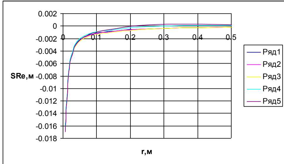
Рис. 3.3.2. Зависимости действительной части осадки от координаты при f=5 Гц.
