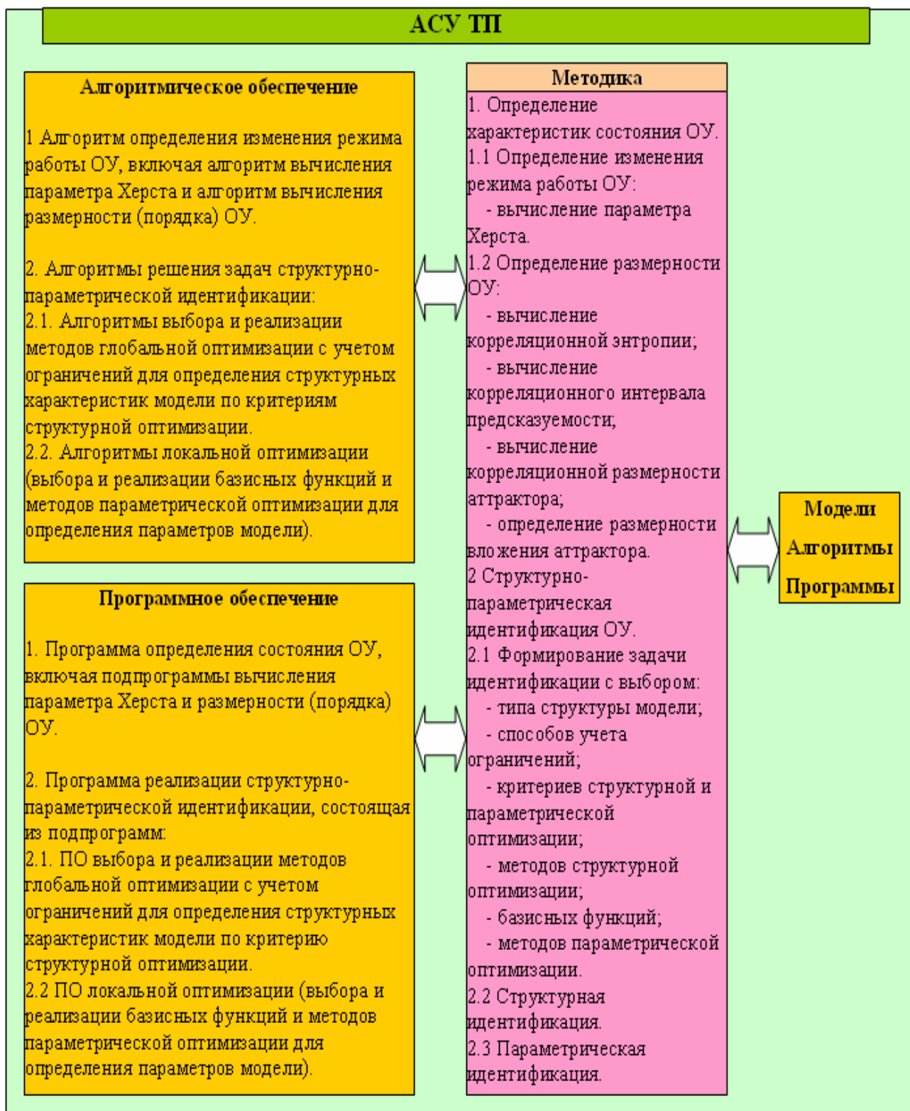
Рис. 4.1. Структура АО и ПО для решения задачи идентификации ОУ в АСУТП рудоподготовки
