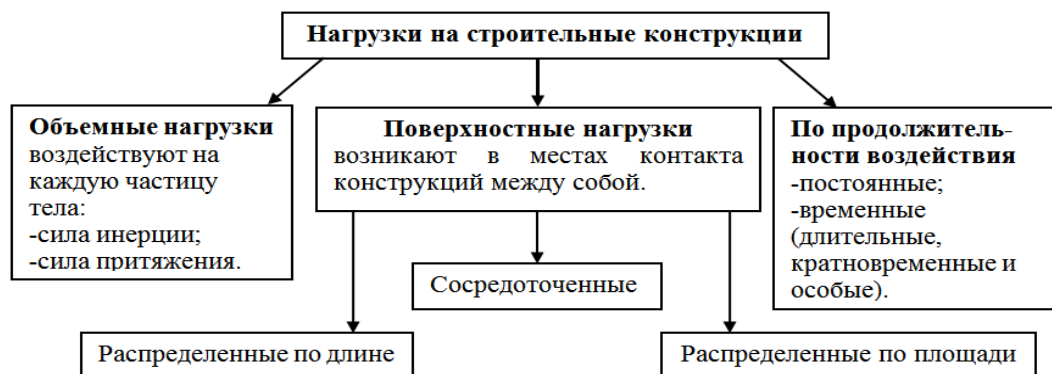
Рис. 4. Нагрузки на строительные конструкции.
