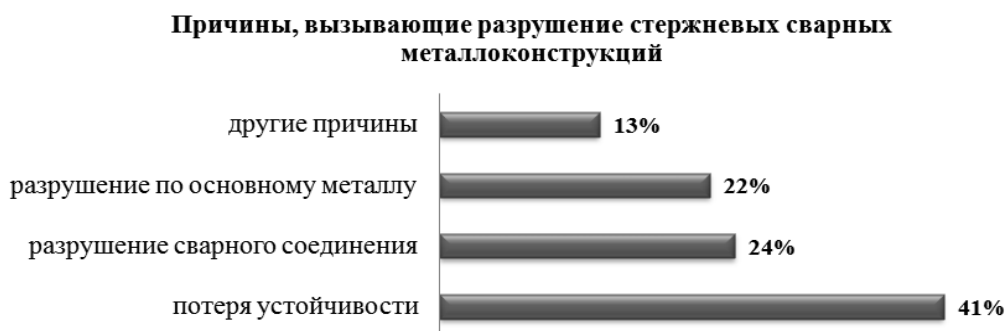
Рис. 8. Некоторые статистические результаты эксплуатации стержневых металлоконструкций.
