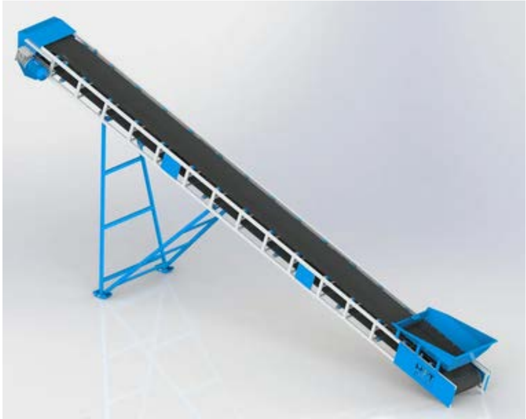
Рисунок 1.8 – Типова конструкція похилого стрічкового конвеєра
