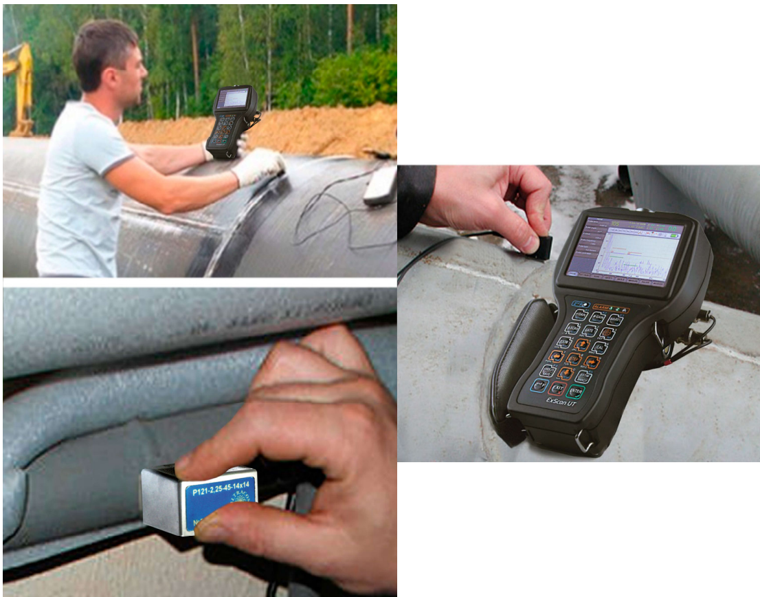
Рисунок 4.6 – Ультразвуковий метод контролю
