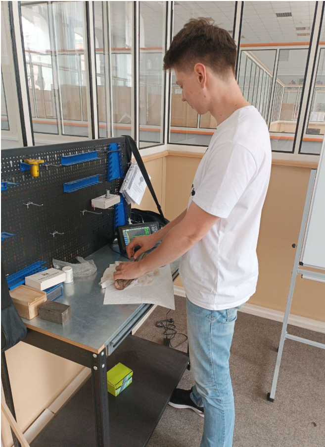
Рисунок 4.13 – Перевірки зварного з'єднання ультразвуковим дефектоскопом
