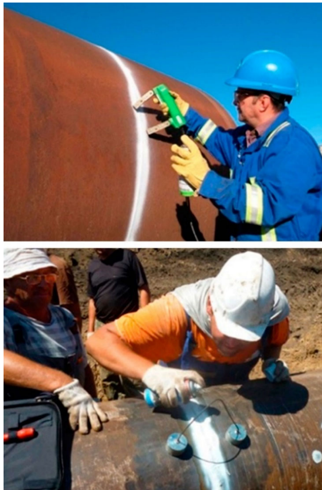
Рисунок 4.5 – Проведення магнітно-порошкового контролю
