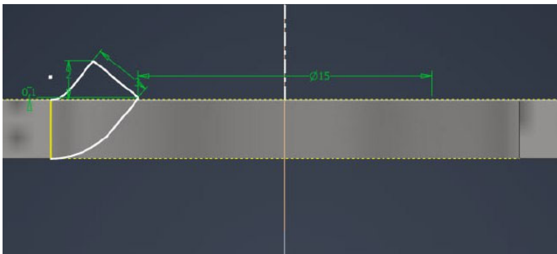
Рисунок 2.8 – Профіль штампованого отвору
