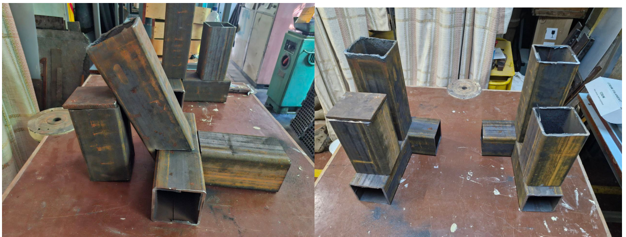
Рисунок 3.5 – Підготовлені металеві елементи до зварбвання
