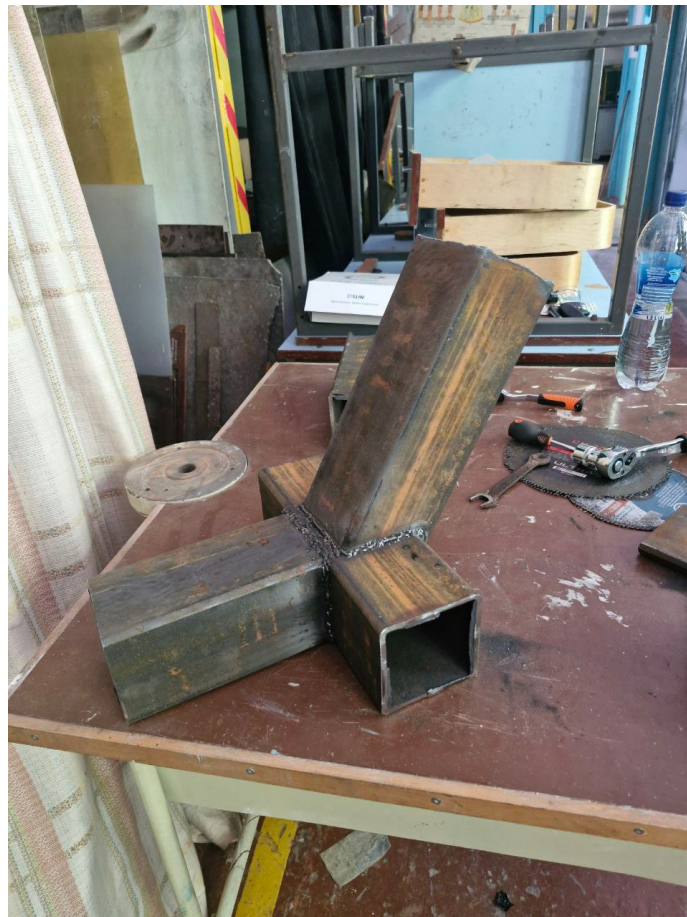
Рисунок 3.6 – Зварена стиковий елемент нижньої частини конструкції
