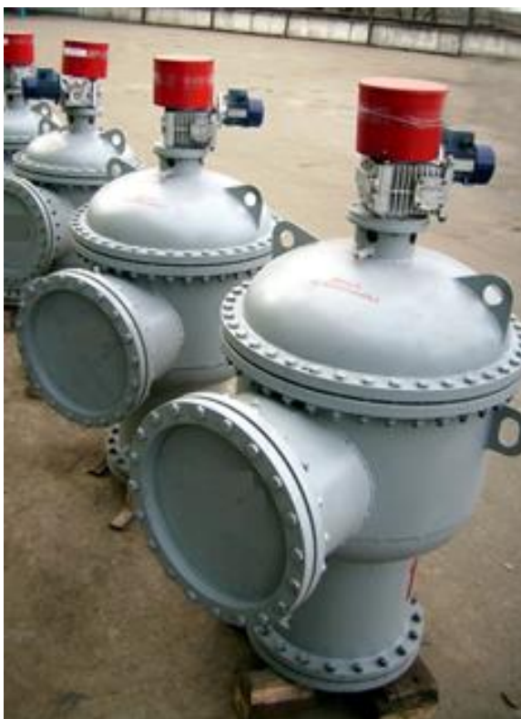
Рисунок 1.6 – Сітчасті фільтри технічної води серії ФСЦ, виробництва [7]
