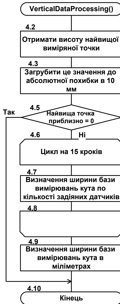
Рисунок 3.3 – Алгоритм функціонального блоку визначення висоти посилки й підготовки даних для розрахунку кута відхилення
