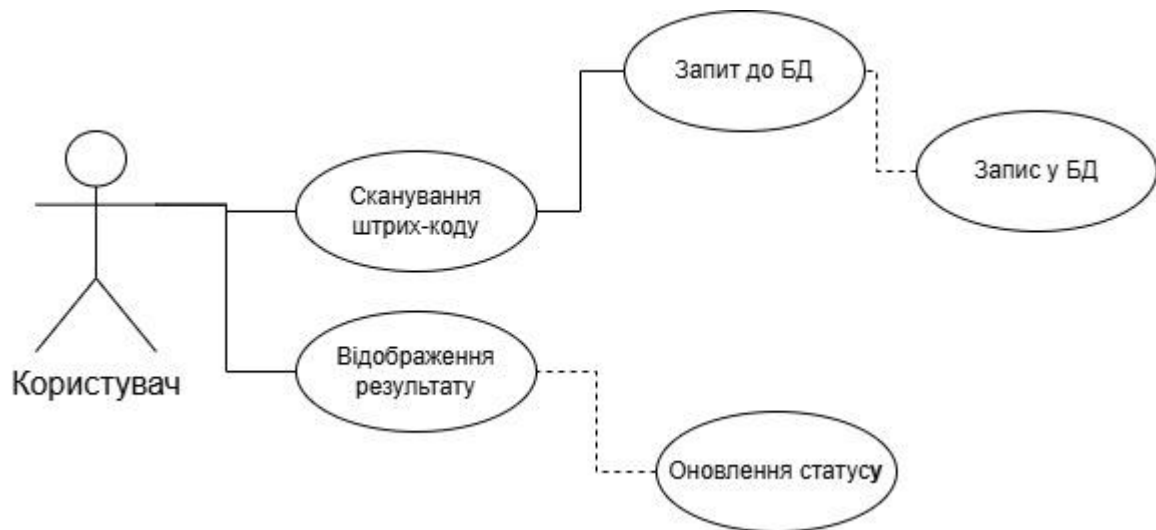
Рисунок 1.9 – UML-діаграма варіантів поведінки користувача
