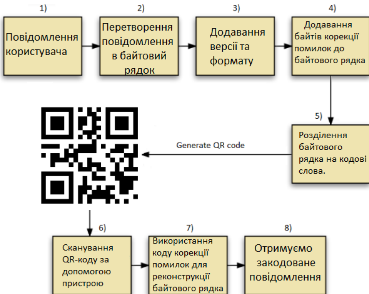
Рисунок 1.4 – Процес кодування та декодування QR-коду
