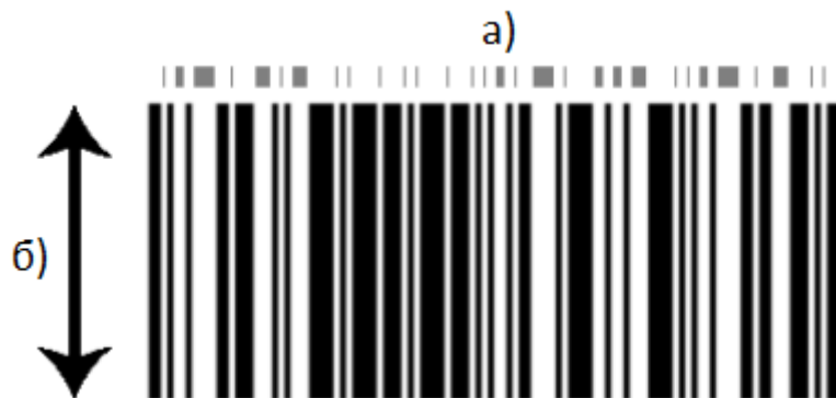
Рисунок 1.1 – Структура одновимірного штрих-коду: а) показує зміну відстані між вертикальними лініями; б) показує, як може змінюватися ширина вертикальних ліній
