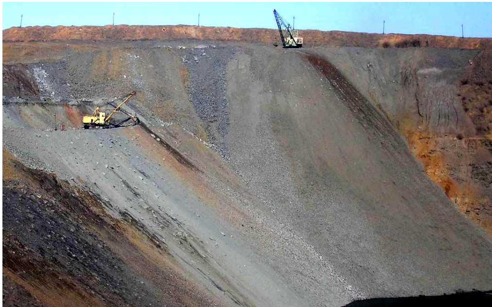
Рис. 6.11. Складування порід розкриву у відпрацьованому кар'єрі №1 ПрАТ «АрселорМіттал Кривий Ріг» екскаваторами ЭКГ-4У і ЭШ-6/40.
