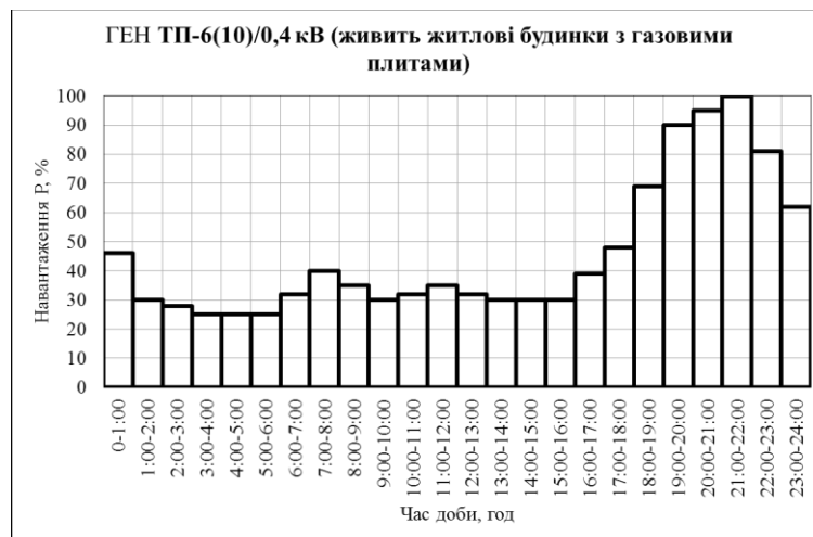
Рисунок 4.7 – ГЕН ТП-6(10)/0,4, що живить житлові будинки з газовими плитами [81]
