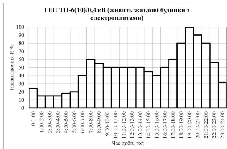
Рисунок 4.8 – ГЕН ТП-6(10)/0,4, що живить житлові будинки з електроплитами [81]
