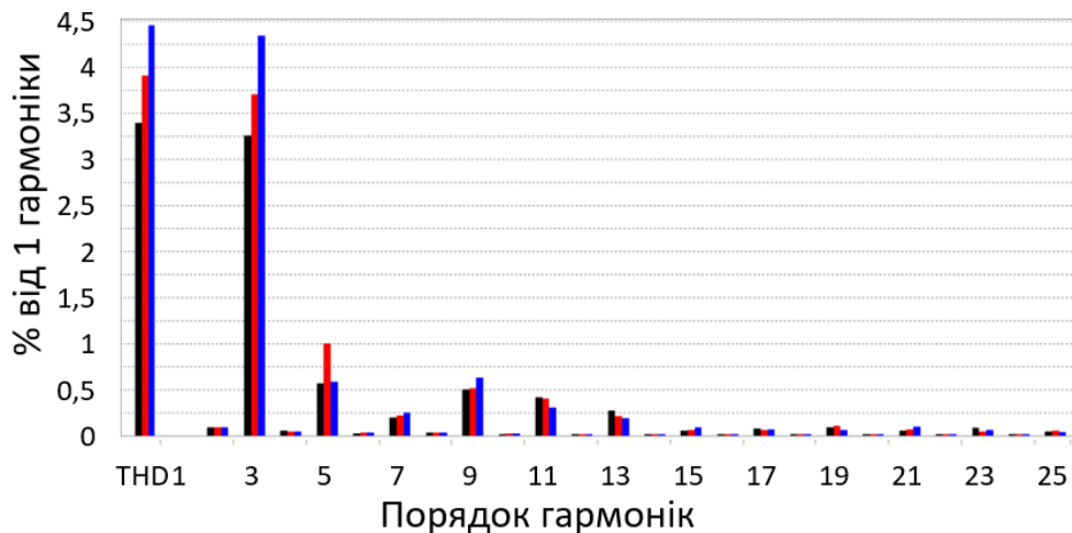
Рисунок 3.14 – Амплітуди вищих гармонік напруги для багатоквартирного житлового будинку з електроплитами
