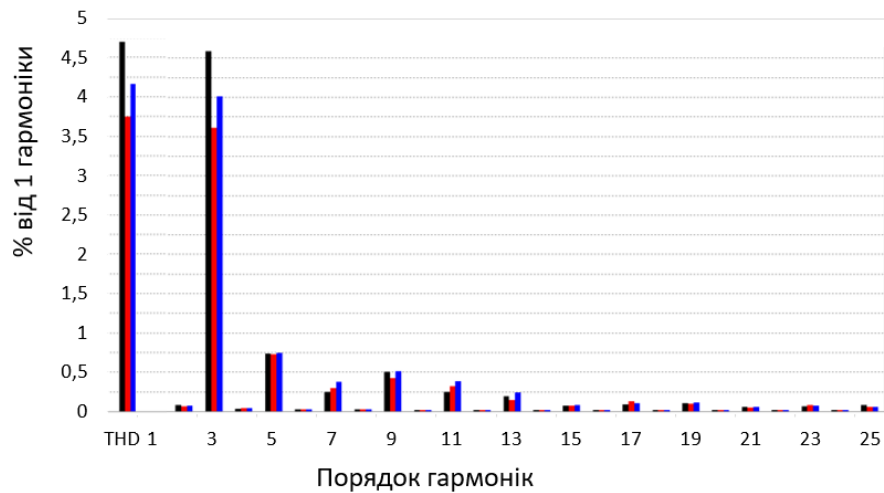
Рисунок 3.16 – Амплітуди вищих гармонік напруги для району з дрібними підприємствами та житловою малоповерховою забудовою
