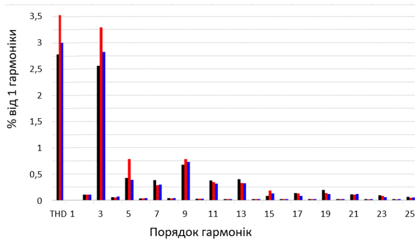
Рисунок 3.12 – Амплітуди вищих гармонік напруги для багатоквартирного житлового будинку з газовими плитами
