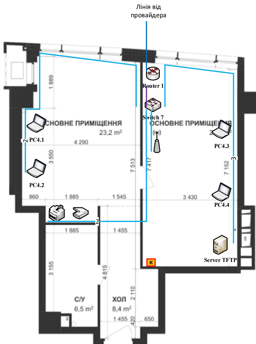
Рисунок 3.2 – Схема розташування кабельних трас офісу «Служби інформаційних технологій»
