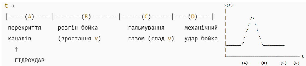
Рис. 4. Узагальнена часова схема робочого циклу гідроударника ПГБ - 2ПГ із якісним характером зміни швидкості бойка
