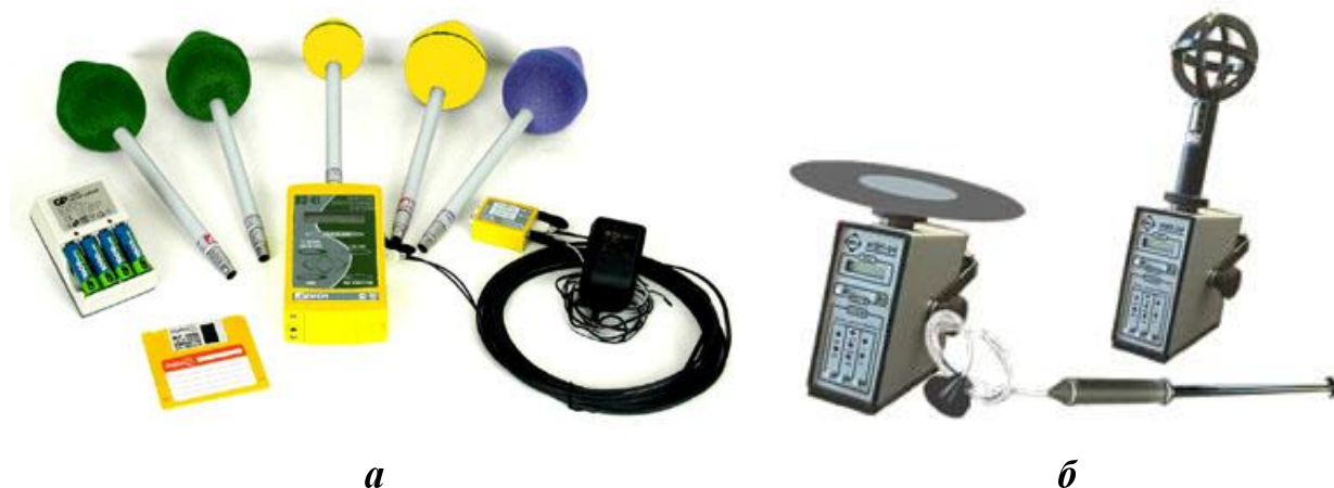
Рис. 2.5. Вимірювачі електромагнітних випромінювань ПЗ-41 (а) та Циклон-4 (б)
