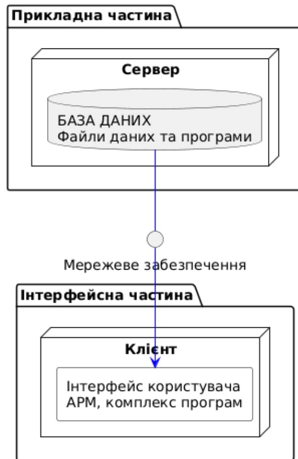
Рисунок 1.2 – Схема взаємодії прикладної та інтерфейсної частин
