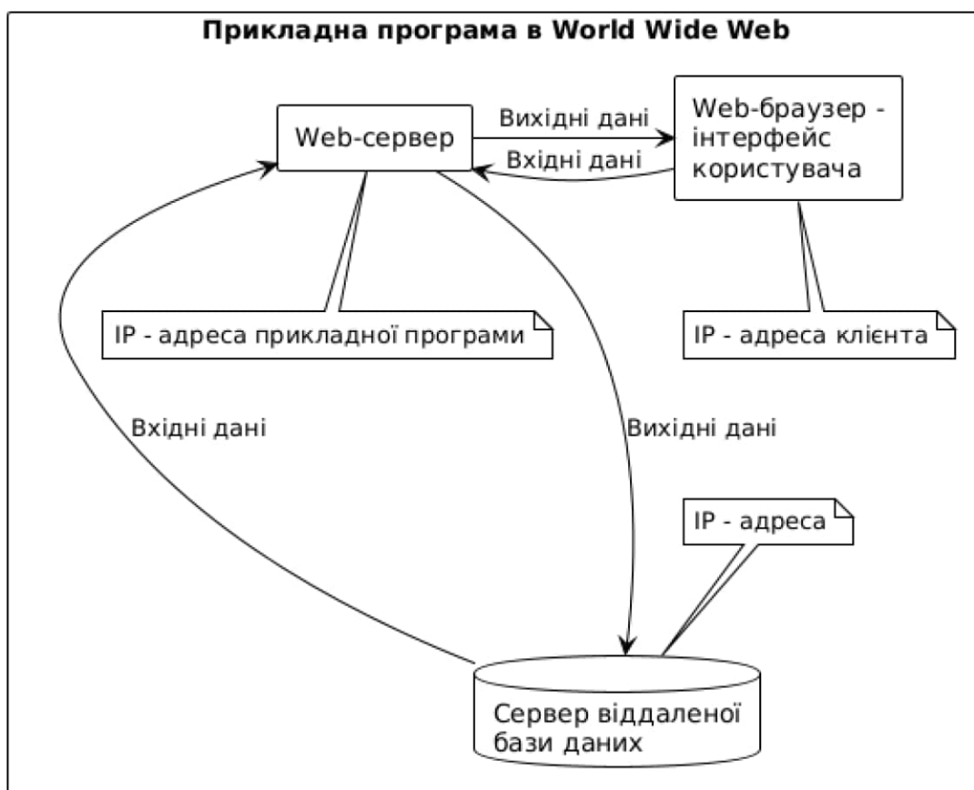
Рисунок 1.3 – Доступ до віддаленої бази даних з допомогою Web - технології
