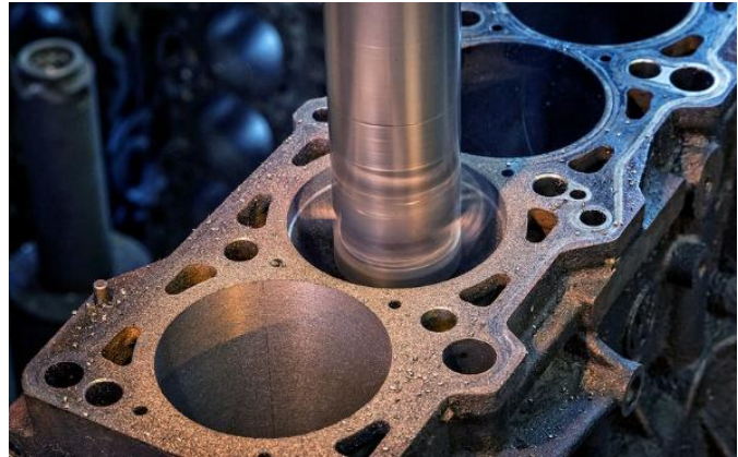
Рисунок 8.4 – Операції розточування гільзи циліндра двигуна
