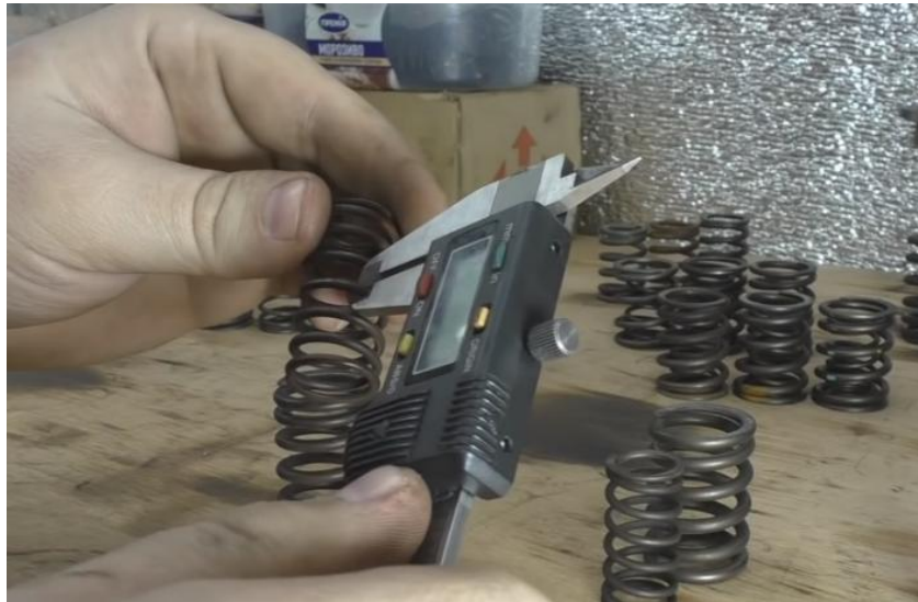
Рисунок 6.6 – Вимірювання діаметра витків дроту ( d )
