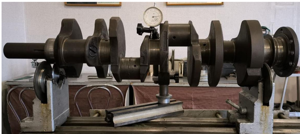
Рисунок 2.7 – Вимірювання биття середньої шийки колінчатого вала
