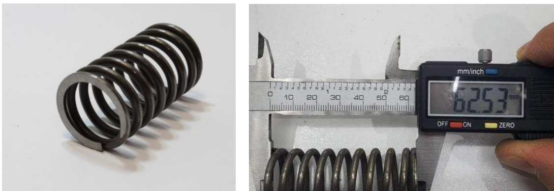
Рисунок 6.4 – Вимірювання довжини пружини у вільному стані ( H_0 )
