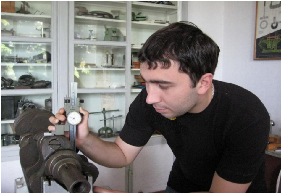
Рисунок 2.6 – Здобувач вищої освіти НТУ «Дніпровська політехніка» виконує вимірювання радіусу кривошипа колінчатого вала
