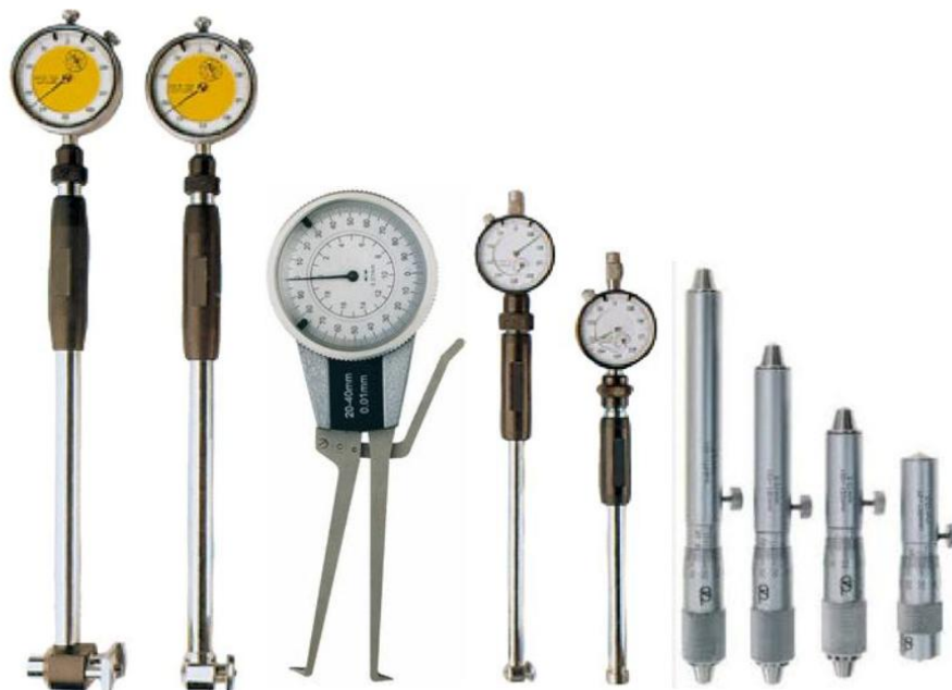
Рисунок 5.9 – Нутроміри індикаторні і мікрометричні
