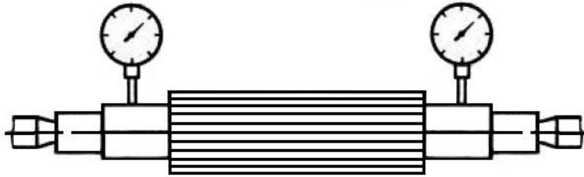
Рисунок 5.13 – Схема контролю неспіввісності шийок валів
