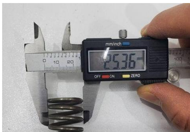
Рисунок 6.5 – Вимірювання зовнішнього діаметра пружини ( D_3 )
