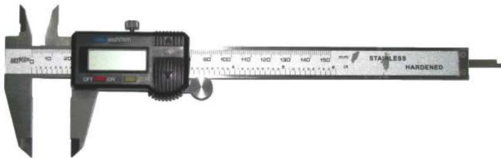
Рисунок 5.2 – Штангенциркуль з електронним відліком
