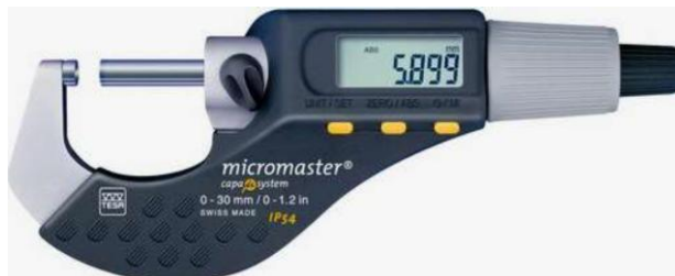
Рисунок 5.6 – Мікрометр з цифровим відліком
