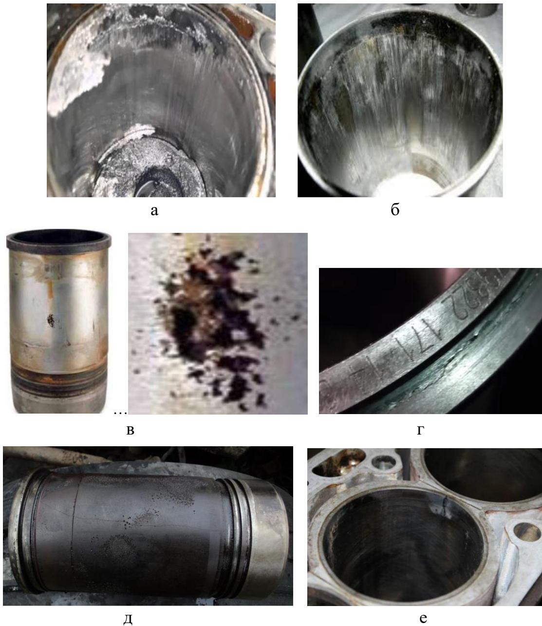
а – задирка дзеркала; б – спрацювання дзеркала; в – кавітаційні пошкодження; г – знос посадкових поясків; д – тріщини на поверхні гільзи; е – надлом бурту Рисунок 1.5 – Дефекти гільзи блоку циліндрів [26], [40], [51]
