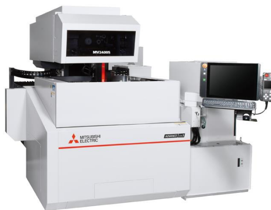
Рис. 3. Електроерозійний верстат MITSUBISHI MV2400S NewGen [9]
