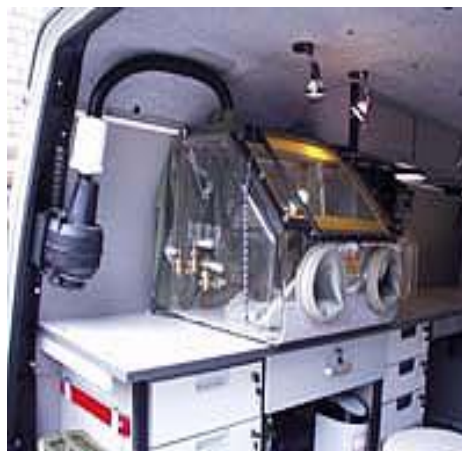
Рис. 2.37. Засоби захисту від дії іонізуючого випромінювання: а – контейнер для зберігання радіоактивних речовин; б – бокс, оснащений спеціальним маніпулятором; в – витяжна шафа
