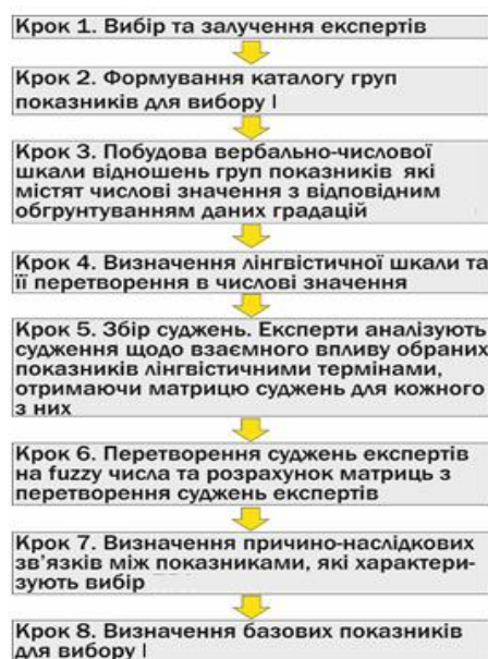
Рис. 2.7. Процес визначення основних груп показників і базових показників для вибору пожежно-рятувального обладнання
