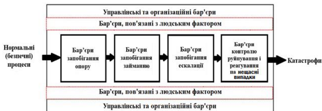
Рис. 1.10. Загальний принцип моделі виявлення, передбачення і запобігання небезпекам
