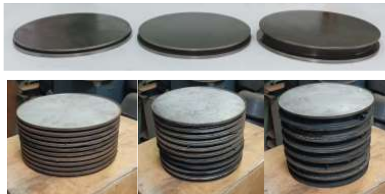
Рисунок 1 – Віброізолятори, що піддавалися лабораторним випробуванням
