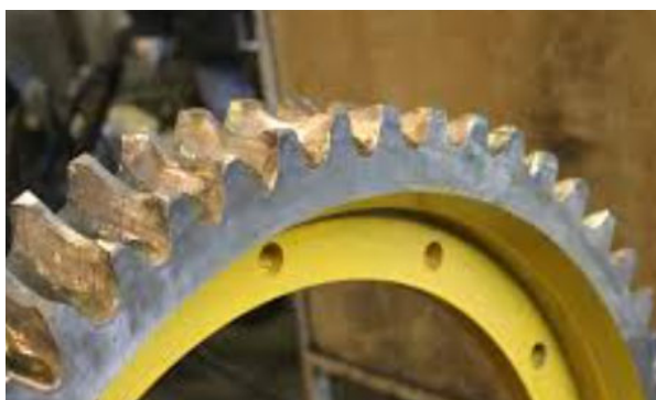
Рисунок 1.4 – Пломка зубу черв'ячного колеса
