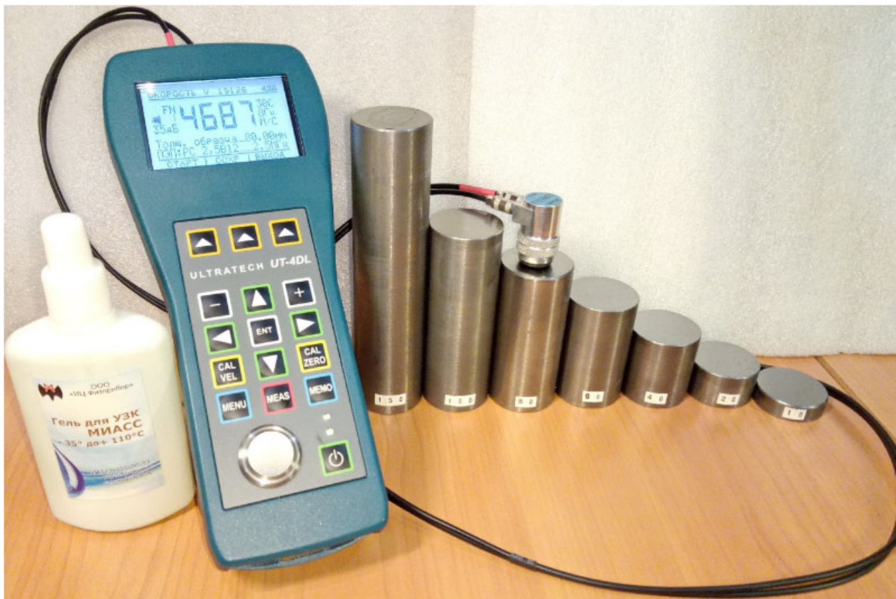
Рисунок 4.5 – Ультразвуковий контроль на стандартних зразках
