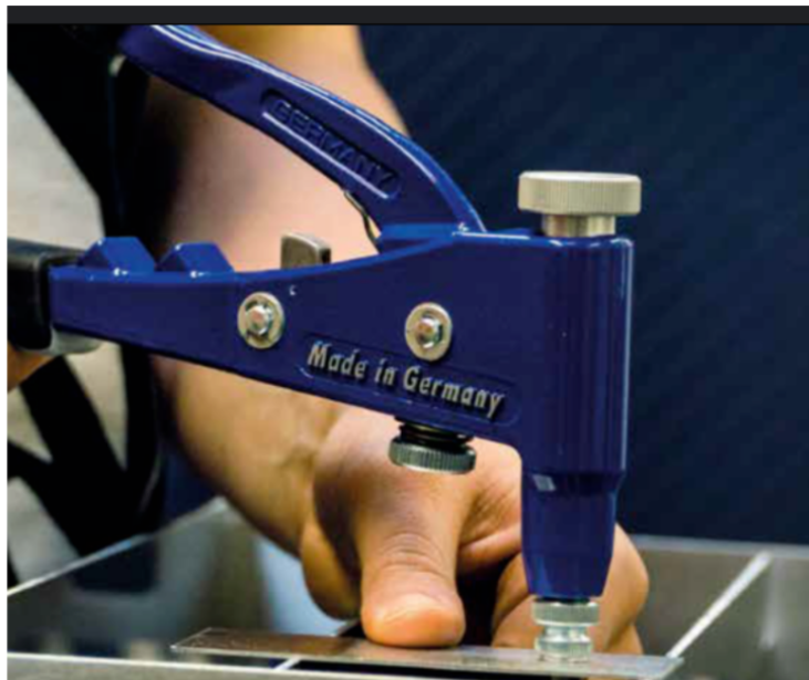
Рисунок 3.10 – Прилад для встановлення гайок-заклепок
