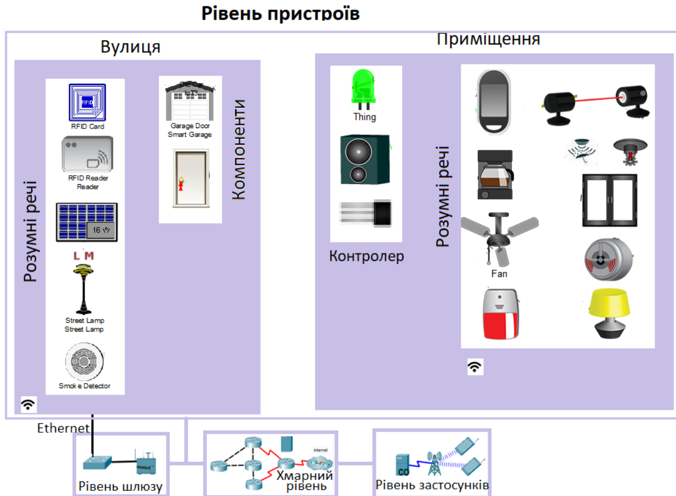
Рисунок 2.1 – Структурна схема компонентів IoT-системи
