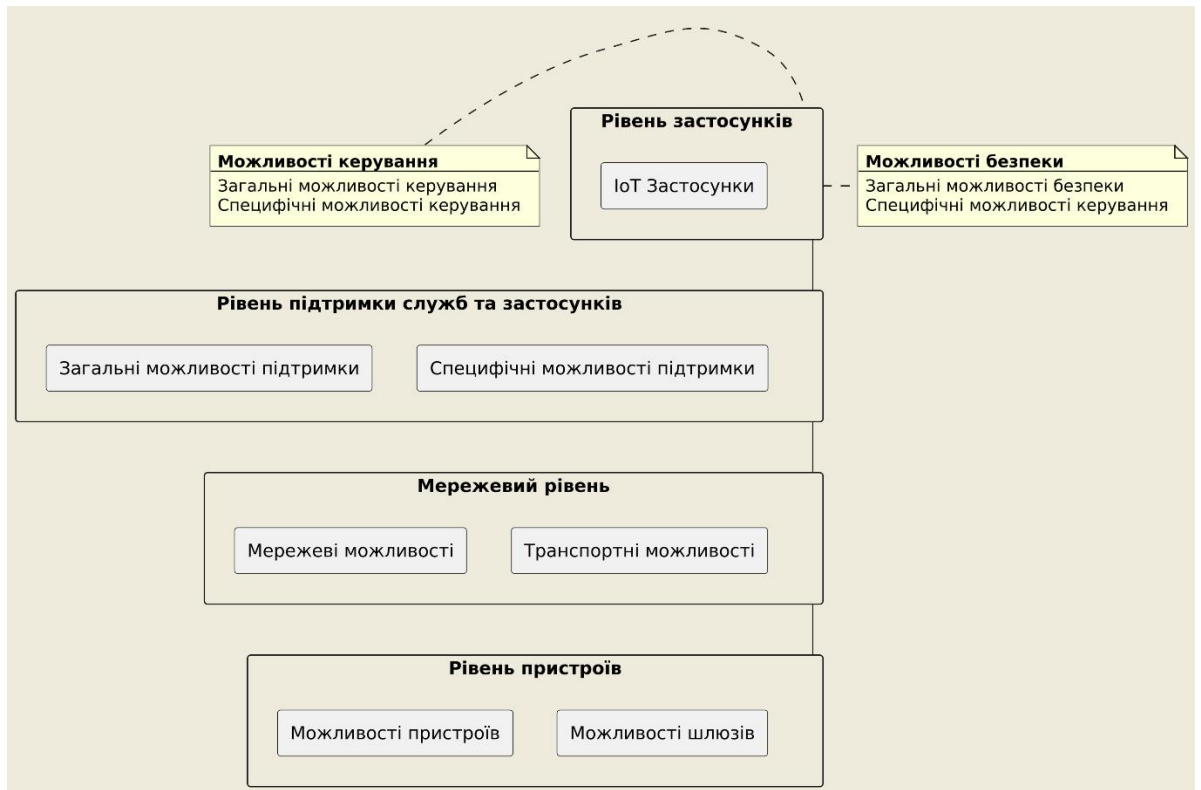
Рисунок 1.1 – Еталонна модель IoT
