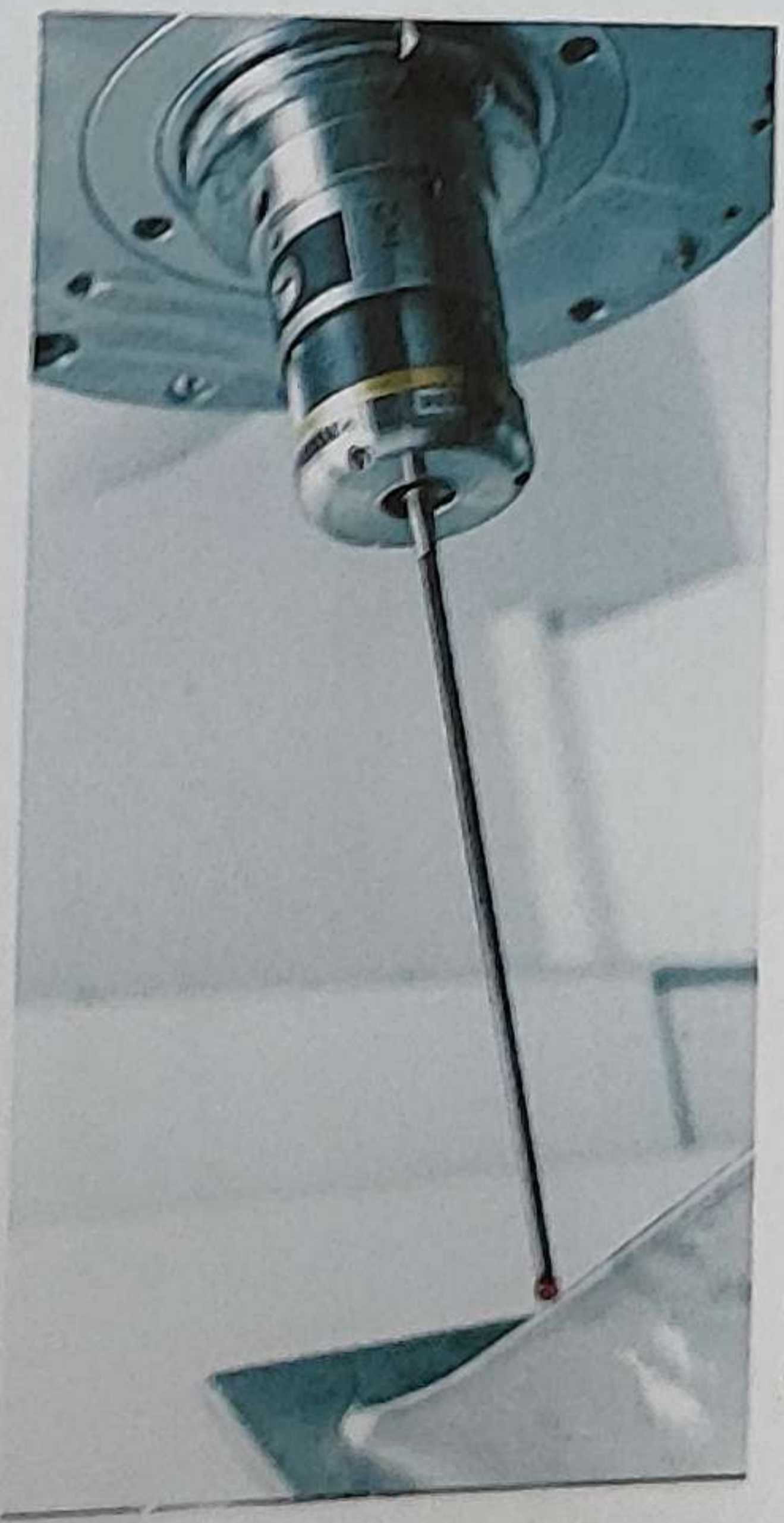
Вид закріплення та робота датчика RENISHAW RMP 600
