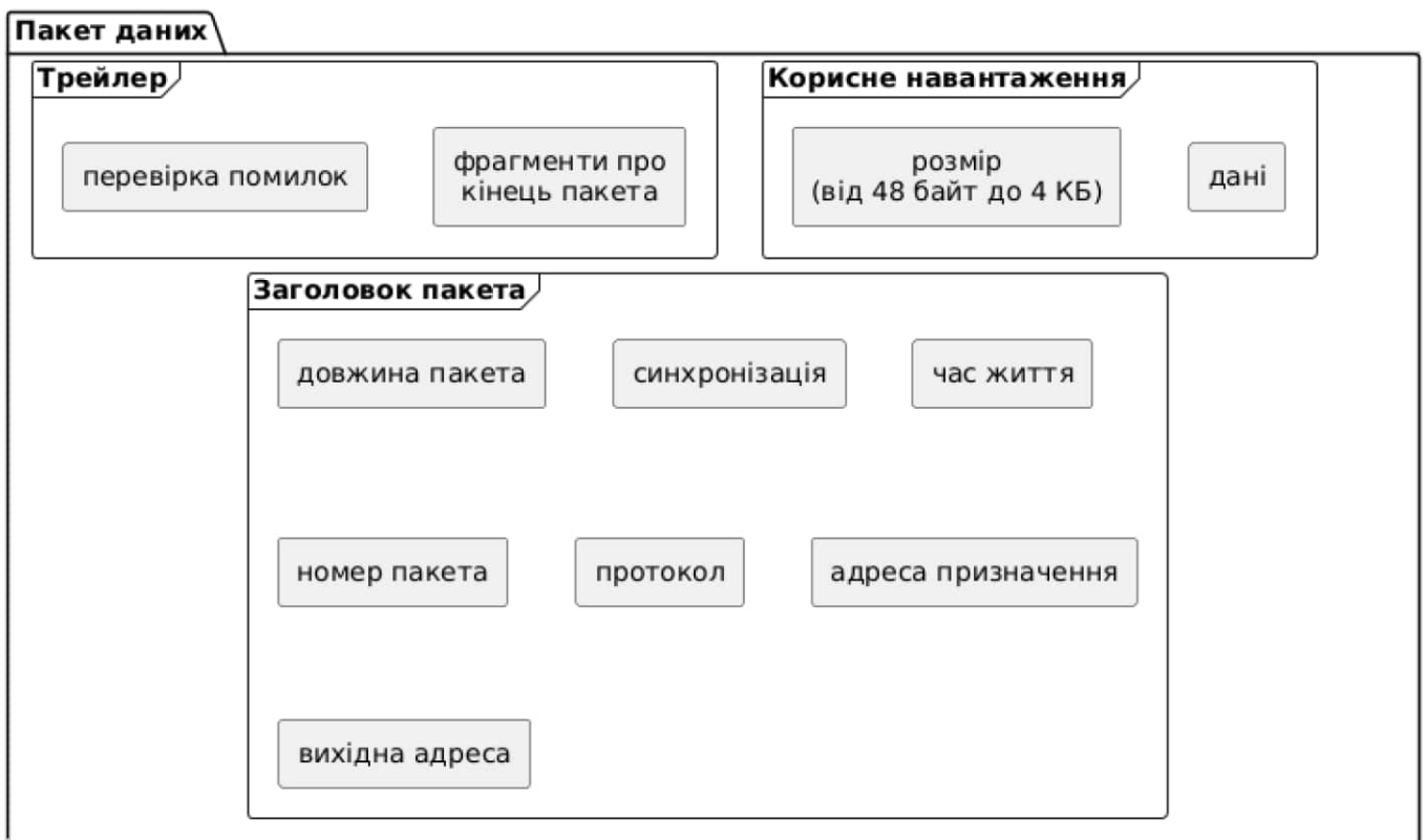
Рисунок 1.2 – Структура мережевого пакету
