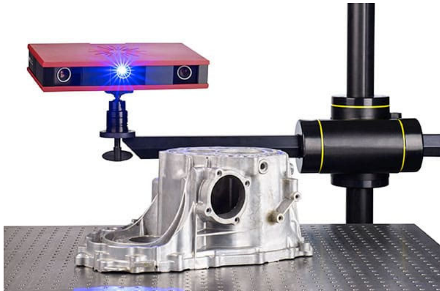
Рисунок 4.5 – 3-Д сканер GOM ATOS Core 45
