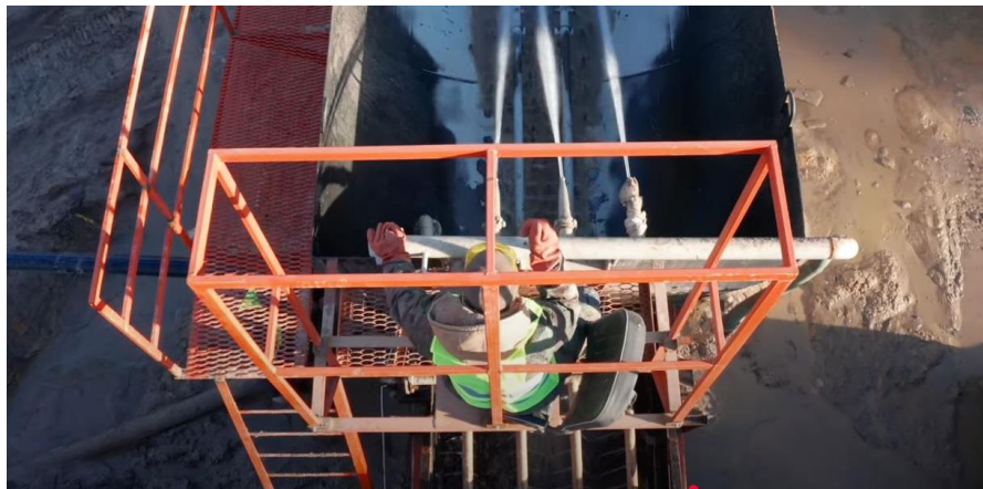
Рис. 3. Розміщення працівника що розбиває породи гідромоніторами в бункері напівмобільної збагачувальної установки
