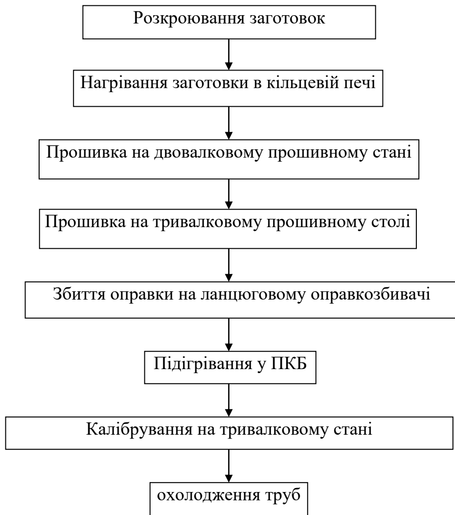
Рисунок 1.2 - Технологічна схема виробництва на ТПА 200
