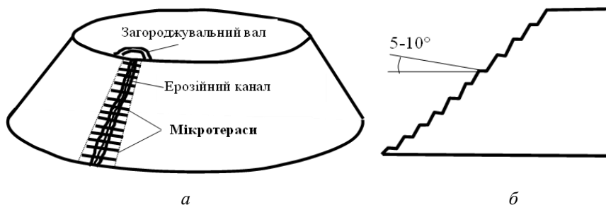
Рис. 4.15 – Схема нарізки мікротерас на схилі породного відвалу: а – загальний вигляд; б – профіль
