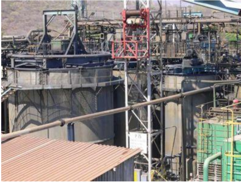
Рис. 1.5 – Реактори Biox® для біоокислення тугоплавкого золота на золотовидобувній шахті Fairview (Барбертон, Південна Африка)
