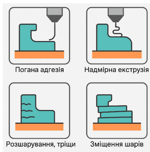
Рисунок 4.2 – Дефекти, які виникають під час 3D-друку
