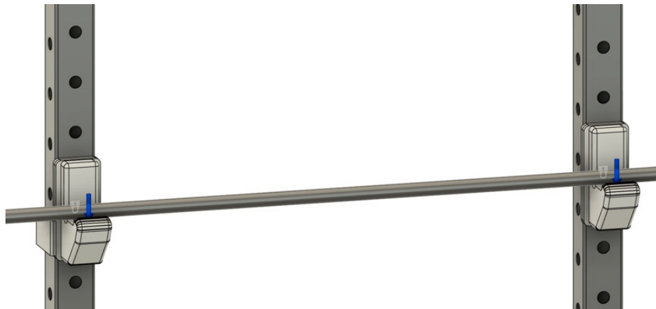
Рисунок 2.8 – Розподіл навантаження штанги між двома фітнес-гачками
