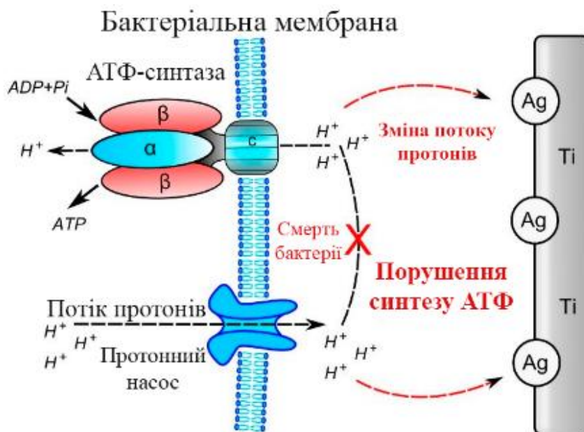
Рисунок 1 - Методи плазмової модифікації поверхні, що створюють особливий тип антимікробної поверхні з використанням наночастинок срібла (Ag), вбудованих у титан (Ti) [3]
