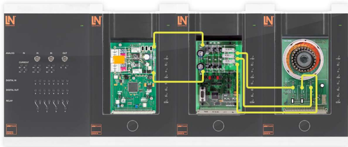
Рис. 8.39. Дослідження типів підключення обмоток електродвигунів. Фінальна конфігурація схеми для зміни напрямку обертання двигуна.
