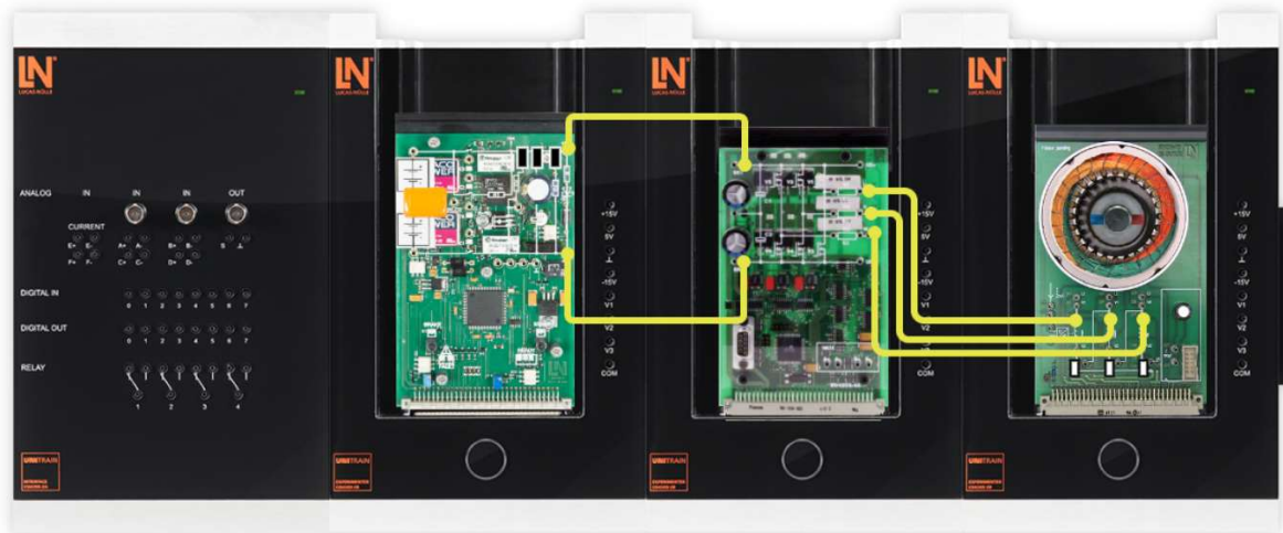
Рис. 8.30. Дослідження асинхронних і синхронних електродвигунів. Фінальна конфігурація схеми для вимірювання швидкості обертання двигуна за допомогою стробоскопа
