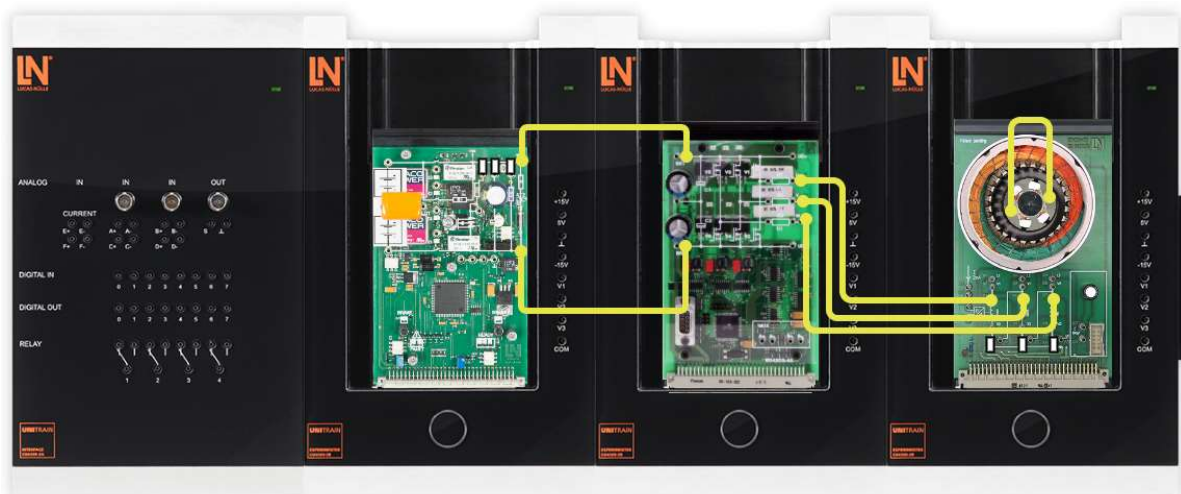
Рис. 8.27. Дослідження асинхронних і синхронних електродвигунів. Фінальна конфігурація схеми для запуску двигуна з ротором з обмоткою
