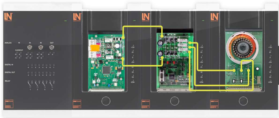
Рис. 8.38. Дослідження типів підключення обмоток електродвигунів. Фінальна конфігурація схеми для зміни напрямку обертання двигуна.
