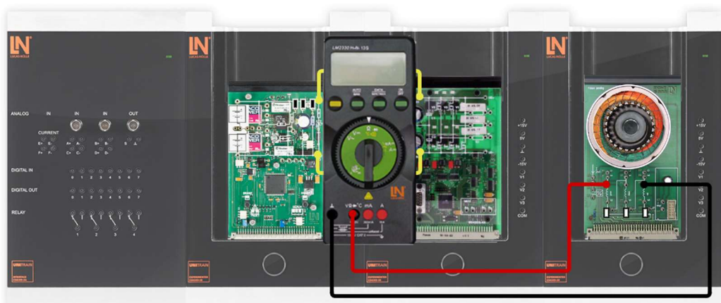
Рис. 8.42. Діагностика електродвигуна. Фінальна конфігурація схеми для вимірювання електричних параметрів електродвигуна
