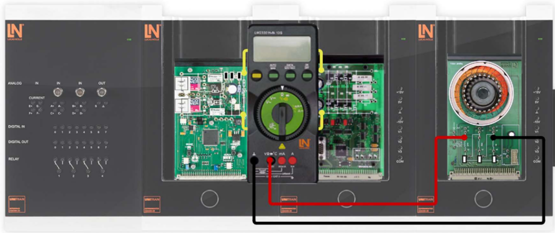
Рис. 8.44. Діагностика електродвигуна. Фінальна конфігурація схеми для усунення несправності в електродвигуні. Випадок № 1
