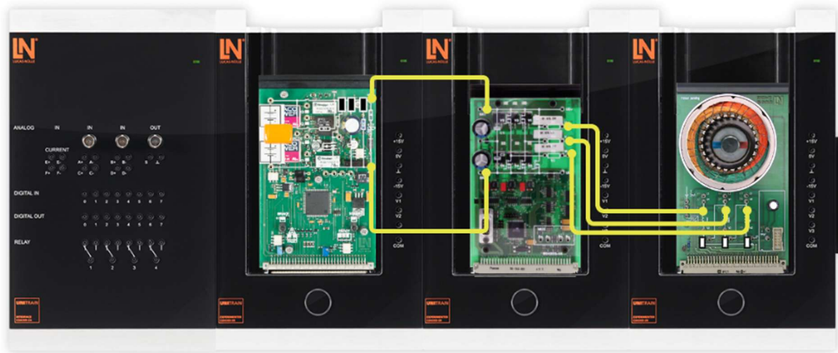
Рис. 8.25. Дослідження асинхронних і синхронних електродвигунів. Фінальна конфігурація схеми для запуску двигуна з ротором із постійними магнітами
