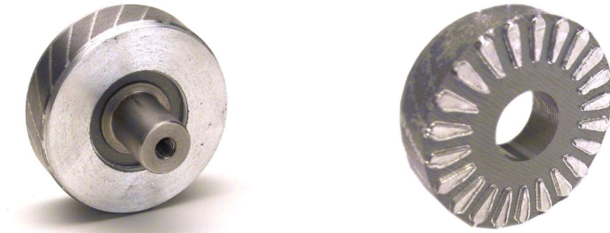
Рис. 8.16. Зовнішній вигляд короткозамкненого ротора стенда LN модуля «Двигун»
