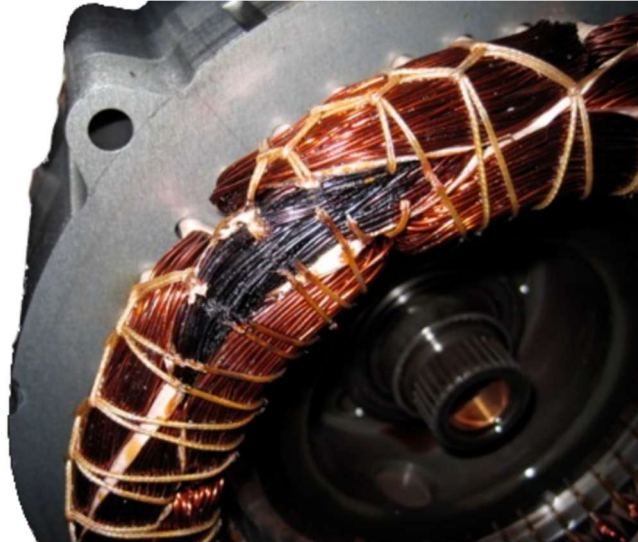
Рис. 8.22. Зовнішній вигляд несправності, що пов'язана з перегоранням обмотки статора
