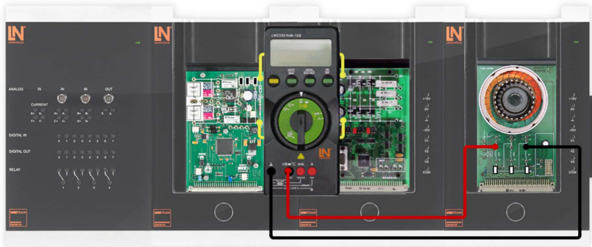
Рис. 8.46. Діагностика електродвигуна. Фінальна конфігурація схеми для усунення несправності в електродвигуні. Випадок № 3
