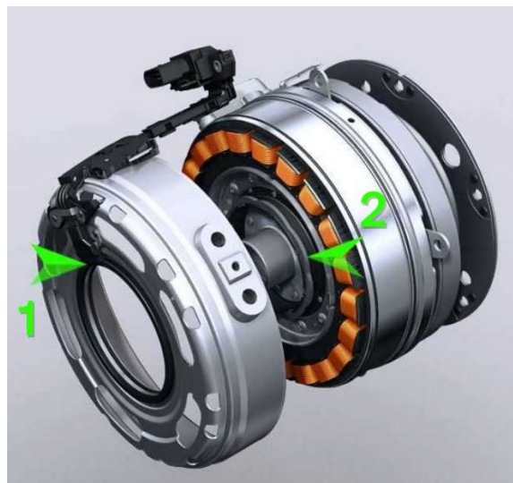
Рис. 8.20. Розміщення резольвера в електродвигуні: 1 – давач; 2 – релюкторне кільце
