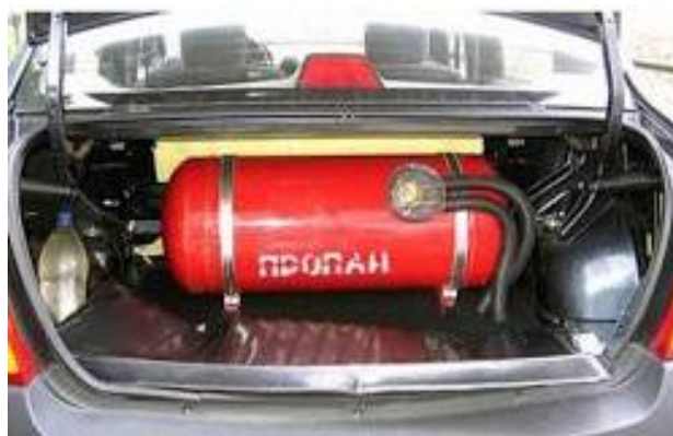
Рисунок 2 – Зменшення об'єму багажного відділення через встановлення газового балона
