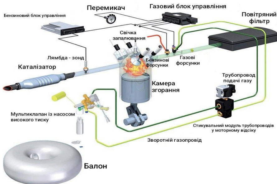
Рисунок 1 – Елементи системи газобалонного обладнання
