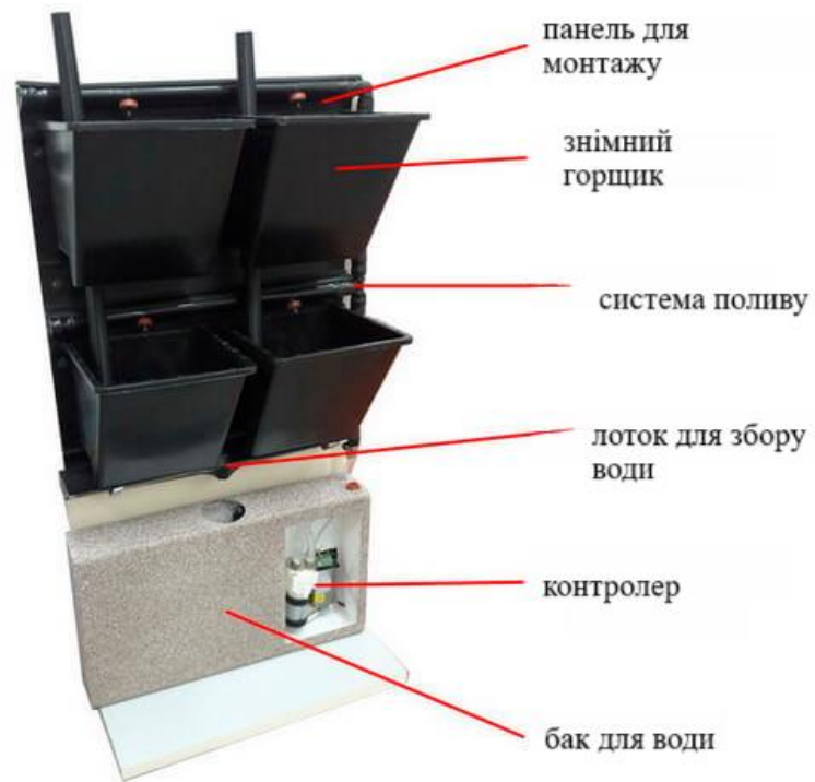
Рисунок 2.1 – Опис компонентів фітостіни
