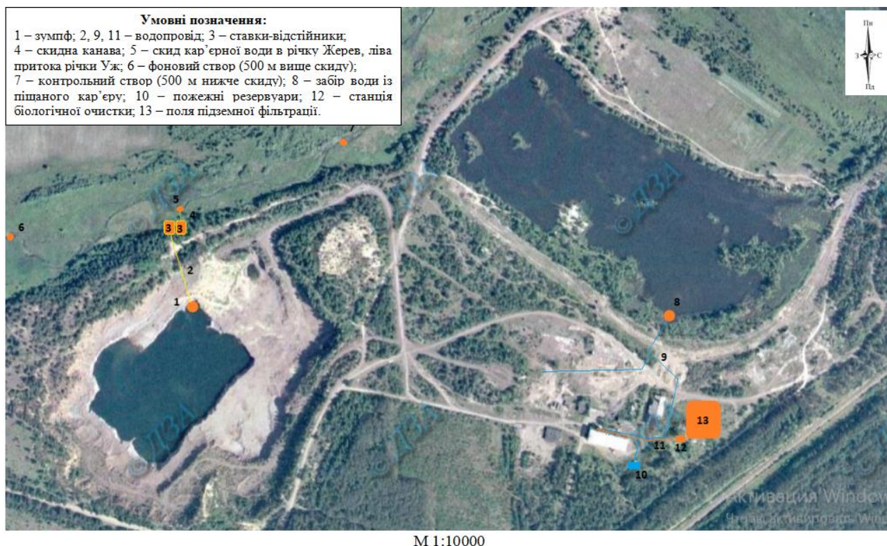
Рис. 7. Схема місць забору води та скиду кар'єрних вод [16]
