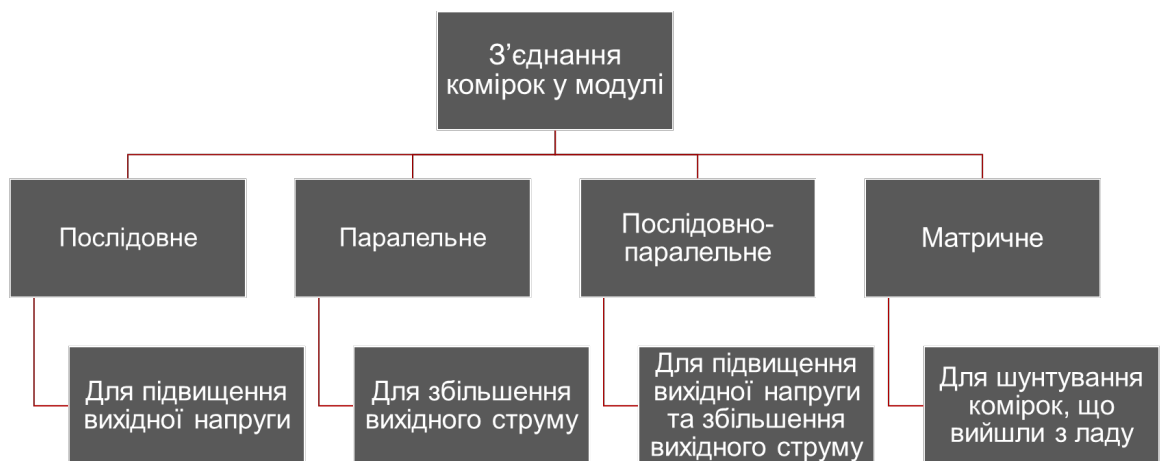
Рис. 4.15. Види з'єднання комірок у модулі
