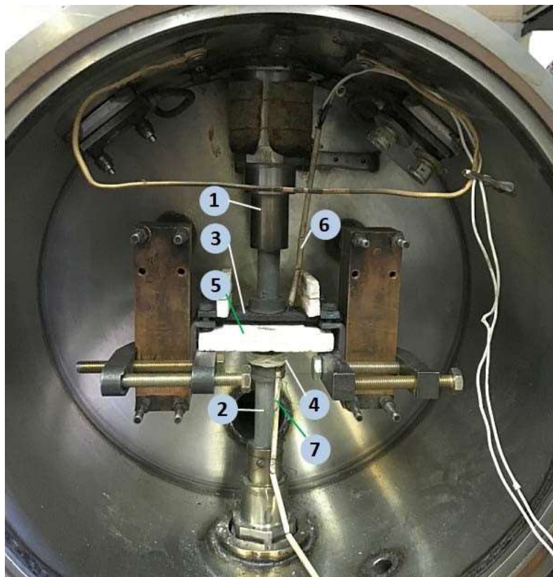
Рисунок 1 –Термокамера з елементами нагрівання та навантаження матеріалу: 1 – верхній нерухомий шток; 2 – нижній рухомий шток; 3– графітовий нагрівач; 4 – зразок конструкції, що досліджується; 5 – вогнетривка заслінка; 6, 7 - термопари
