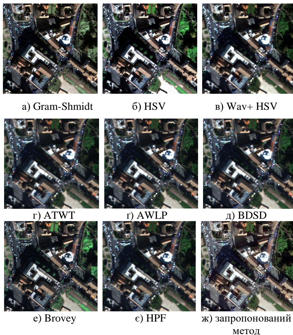
Рисунок 3.5 – Порівняння різних методів злиття
