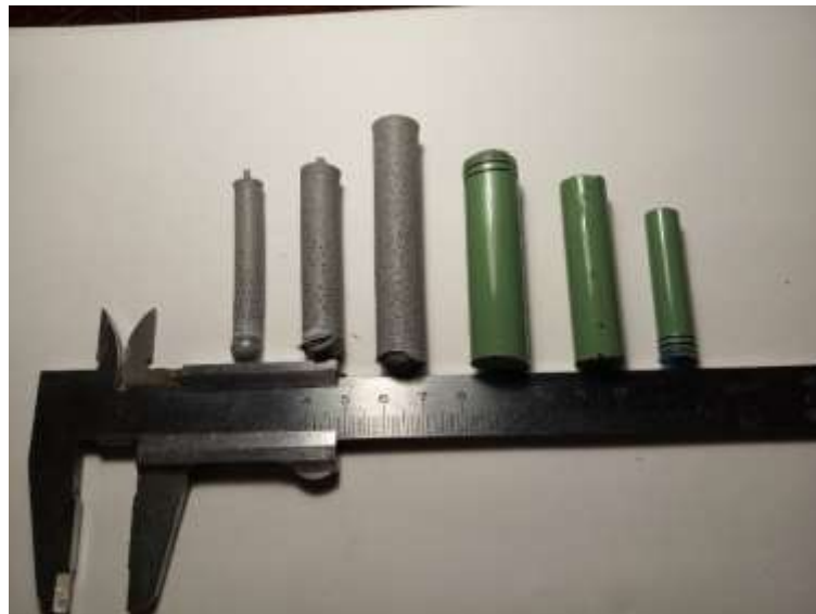
Рисунок 1 – Сформовані за допомогою пластикового шприца дослідні зразки сірого кольору - АК.UR-03 («Капітел», Дніпро), та зеленого кольору - ДК2 (ПДТУ).
