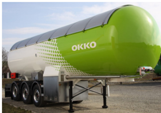
Рис. 2. – Цистерна-напівпричіп для транспортування та тимчасового зберігання зріджених вуглеводневих газів
