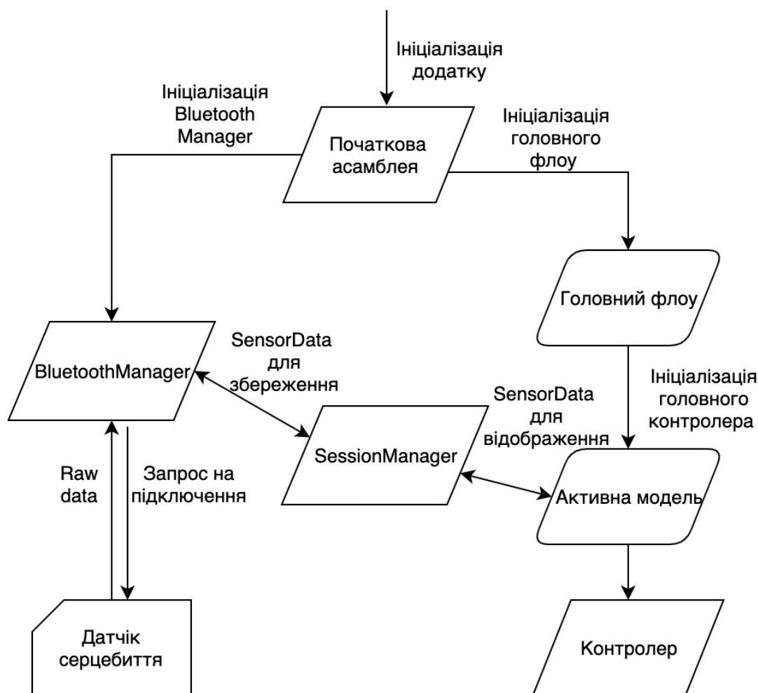
Рисунок 3.6 - Схематичне відображення роботи менеджера з блютуз-з'єднанням.
