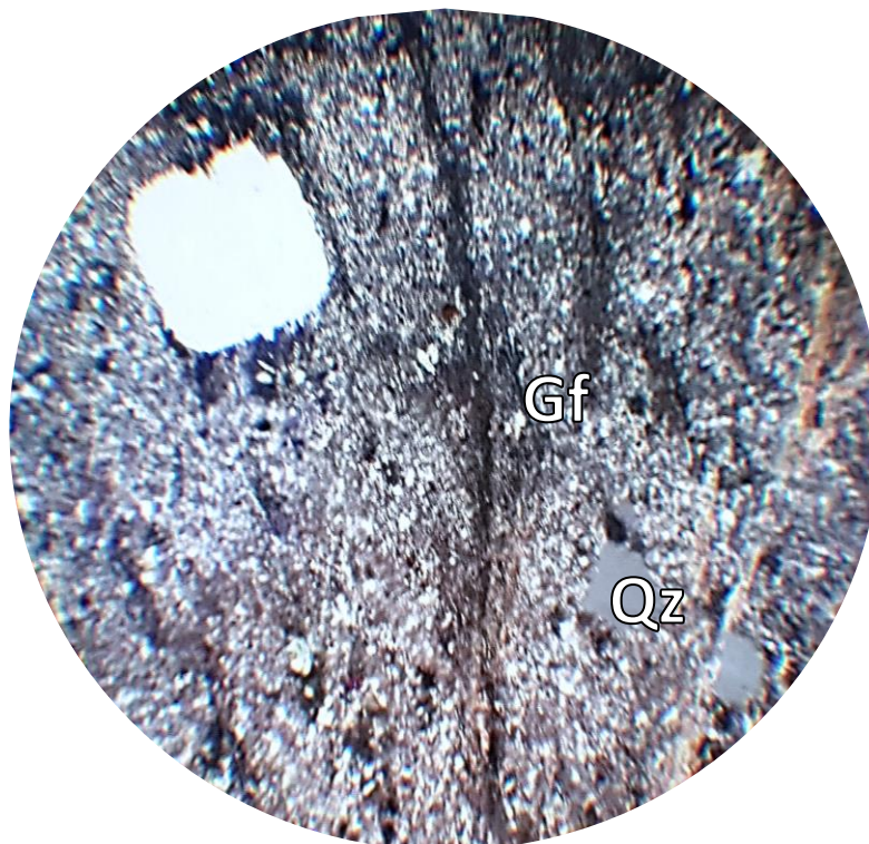
Рисунок 2.20 - Зерно кварцу з «тінями тиску», які виповнені серицит-кварцевою речовиною, графітизація по тріщинах та серицитизація цементу метаконгломератобрекчії. Ник +, зб.90
