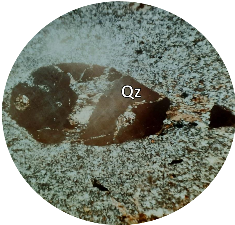
Рисунок 3.4 — Структура «in situ» (підірваних на місці ксенолітів) уламку кварцу та флюїдальність серицитових агрегатів з корозією кварцевих зерен.
