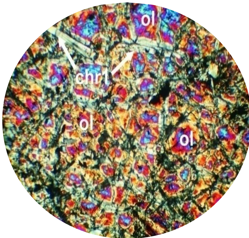
Рисунок 2.30 – Релікти олівінового зерна у хризотиловому серпентиніті. Збільшення 90X; Нік +
