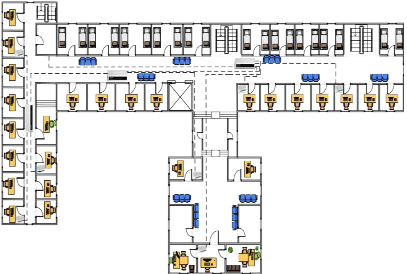
Рисунок 2.7 – Схема мережі технологічної компанії Playtech
