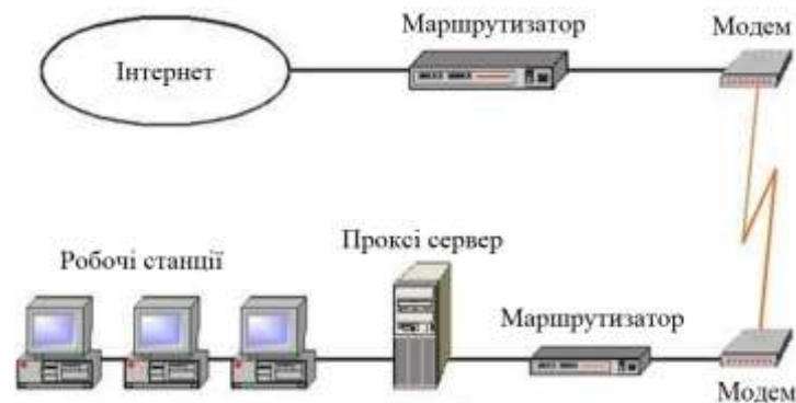
Рисунок 2.8 – Структурна схема інтернет-провайдера
