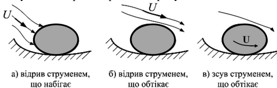
Рис. 3.4. Огляд можливих схем відриву частинок зруйнованої ГП від вибою
