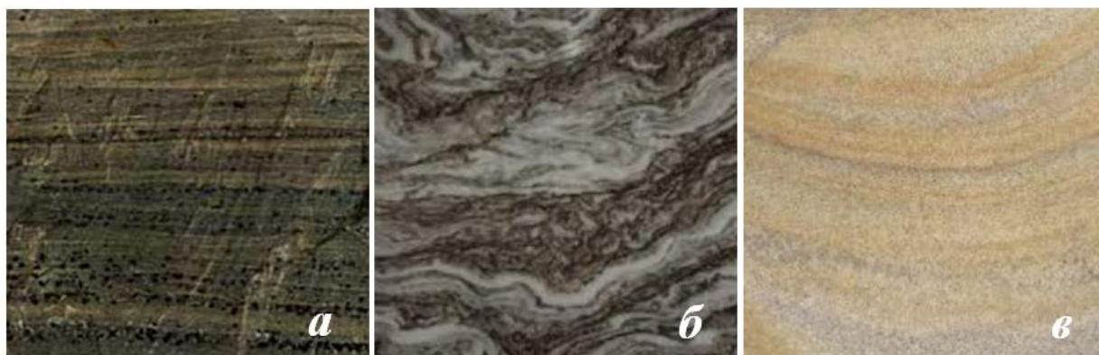
Рис. 3.8. Випробовувані за дослідного буріння зразки ГП: роговик (а), мармур (б), пісковик (в)
