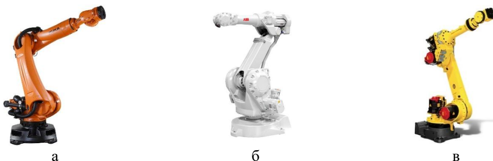
Рис. 1 – Приклади промислових роботів: а - KUKA Robot Arms; б – Robot 6 axes industriel ABB IRB 2400/16; в – FANUC R-1000iA/80F
